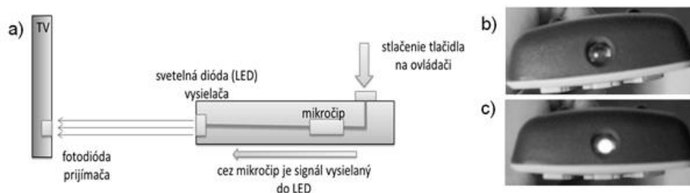
Obr. G-1 a) schéma DO s prijímačom; Záznam z obrazovky fotoaparátu b) DO vypnutý, c) DO zapnutý
