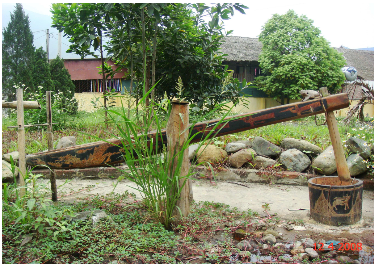
Obrázok 1 Vodný mažiar na lúpanie ryže.
