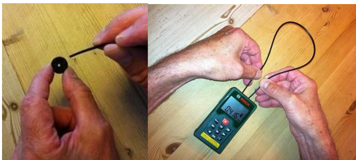
Obrázok 1.5 (a) Podložka a optický kábel. (b) Priloženie optického kábla.
