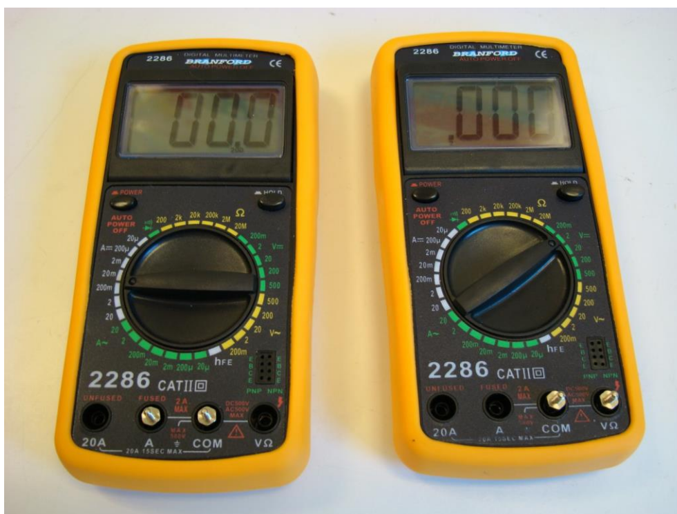
Obrázok 2.3 Multimetre s voľnými svorkami na použitie ako ampérmetr (vľavo) a voltmetr (vpravo). Prístroj sa zapne stlačením “POWER” v ľavom hornom rohu. Prístroj sa vypne automaticky po určitom čase nečinnosti. Môže merať jednosmerný prúd a napätie (=) alebo striedavý prúd a napätie (~). Vnútorňý odpor voltmetra je 10 M \Omega pre všetky rozsahy. Napätie na svorkách ampérmetra je 200 mV pri plnom rozsahu displeja bez ohľadu na rozsah merania. Pri prekročení rozsahu sa na displeji objaví “1” a v tom prípade treba prepnúť rozsah. Tlačidlo “HOLD” (vpravo hore) netreba stláčať, iba ak by ste chceli podržať nameranú hodnotu.
